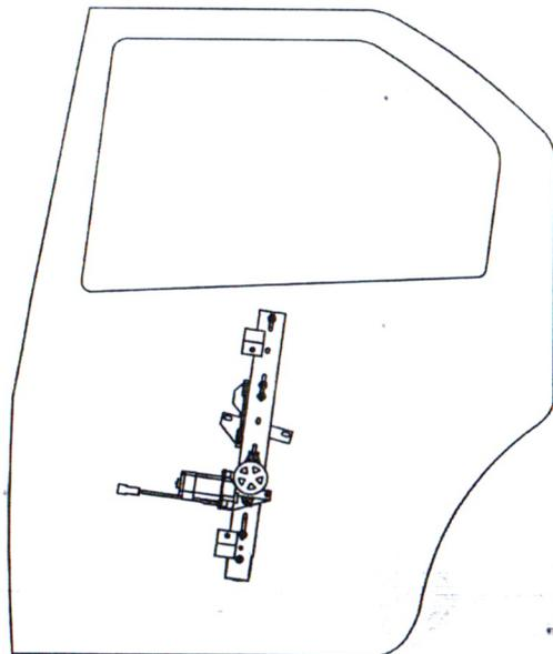
Правильность направления перемещения стекла контролируют пробными включениями стеклоподъемников. При необходимости гнезда в колодке меняют местами.
