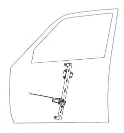
крепежные детали заменяемых стеклоподъемников. Ориентация стеклоподъемников в двери (вид из салона на правую дверь, левый - зеркально) согласно рис.
