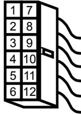
КОЛОДКА 12-КОНТ. РАЗЪЁМА (МАМА)
